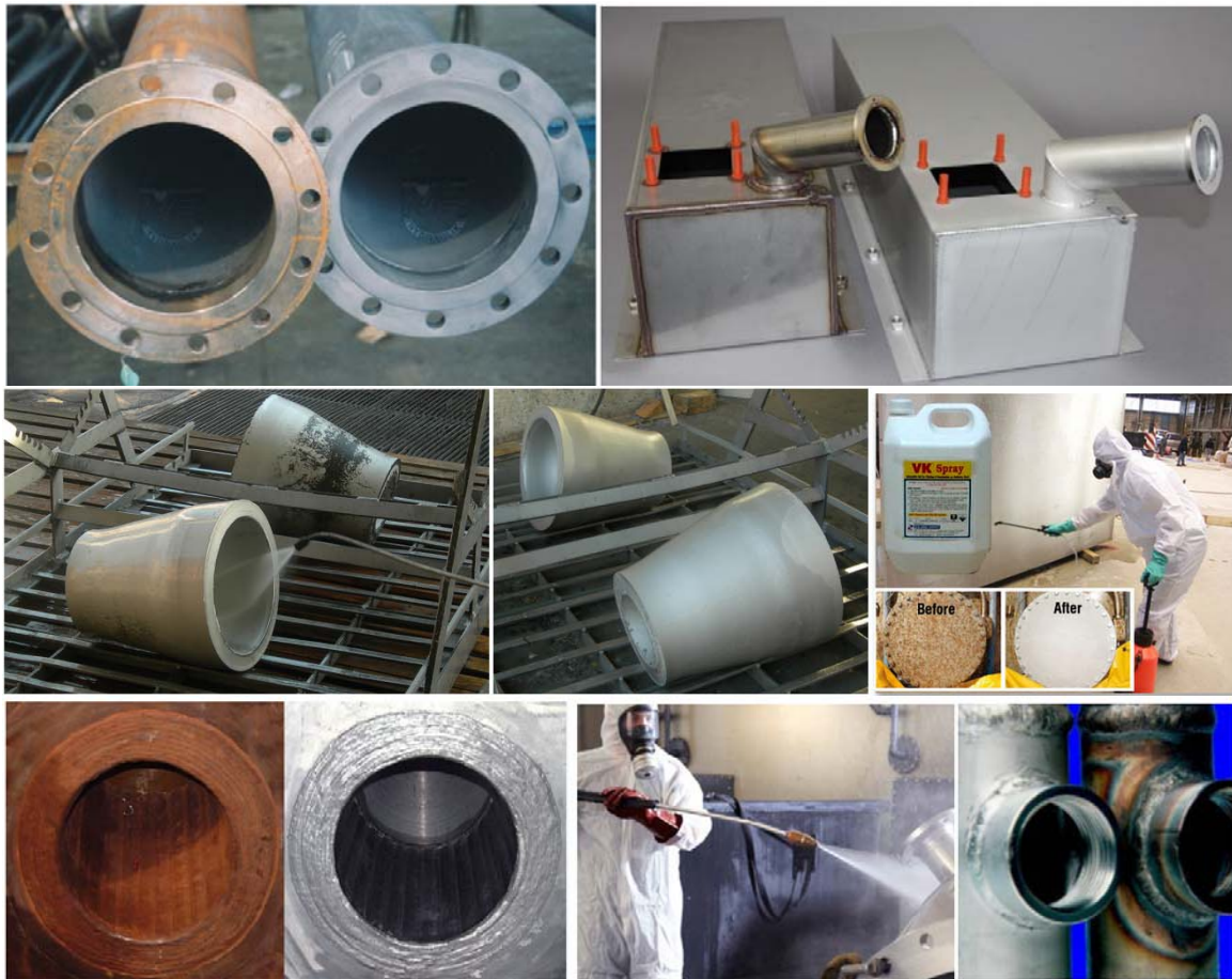
شکل-۵۵: نمایی از انجام عملیات Passivation با مقایسه قبل و بعد از انجام
