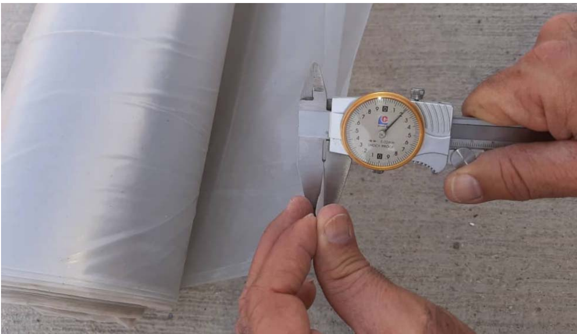
شکل-۷۰: ضخامت دو لایه پلاستیک مورد استفاده در Rupture ۲۰۰ میکرون (0.2 mm)
