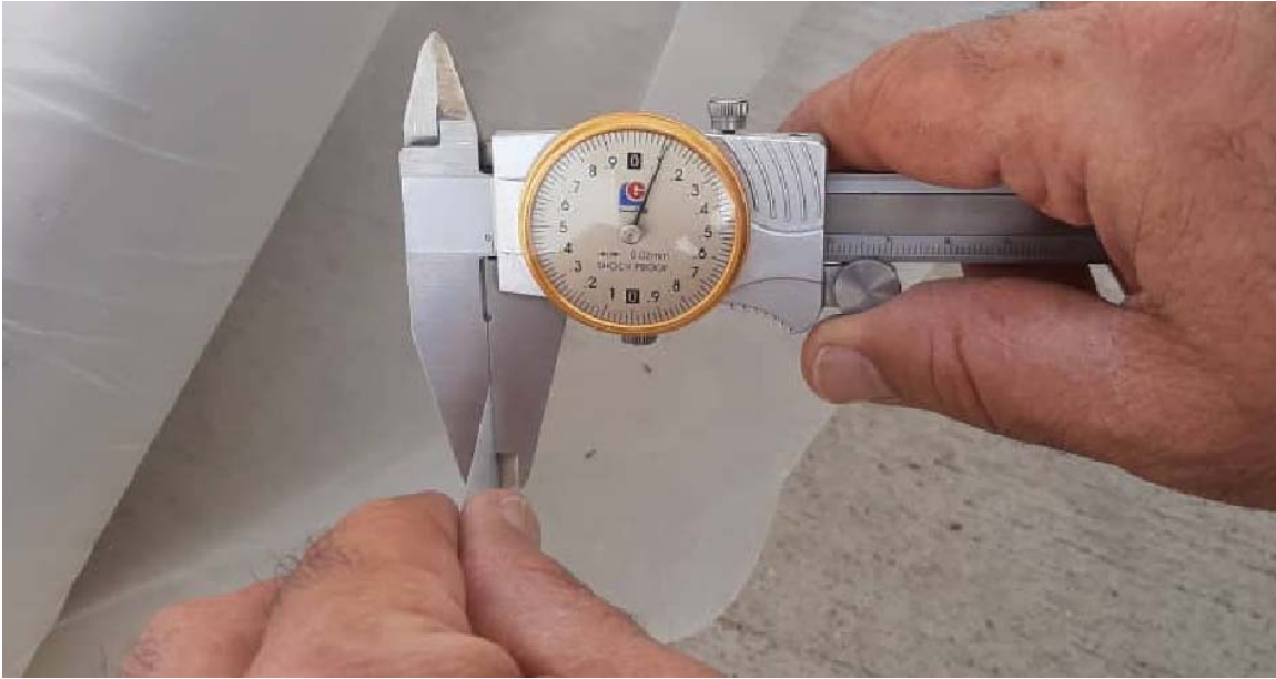
شکل-۶۹: ضخامت یک لایه پلاستیک مورد استفاده در Rupture ۱۰۰ میکرون (0.1 mm)
